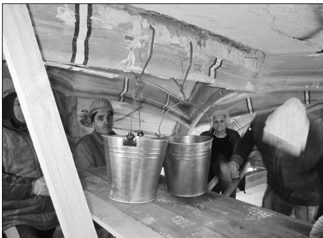
■ Foto 7. Testarea stratului de lipire a nervurilor prin supraîncărcarea locală a acestora
