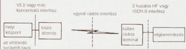
3. ábra. Kis sebességű MPMP rendszer felépítése
