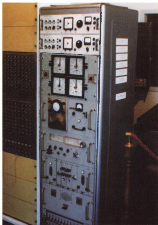
A Magyar Rádió központi órája, a may-fingeni (Anglia) RH. órajelek vételére. Tervezte: Szabó M. Kivitelezte: a Magyar Rádió Alkotógárdája. Folyamatosan üzemelt 1964-1990 között!
