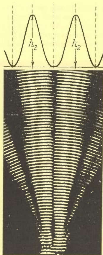
5. ábra. Hullám diffrakció vázlatja és intenzitáseloszlásának diagramja (R. W. Pohl ábrából készült montázs)
