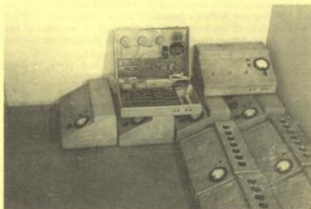
12 darab hordozható erősítőt építettek a külső közvetítések céljaira. Telepes hordozható erősítők szerelés alatt. (Ballagi konstrukció 1946-47.) Két és négycsatornás kivitel, az aluöntvény dobozt kivéve teljesen házi gyártás.
