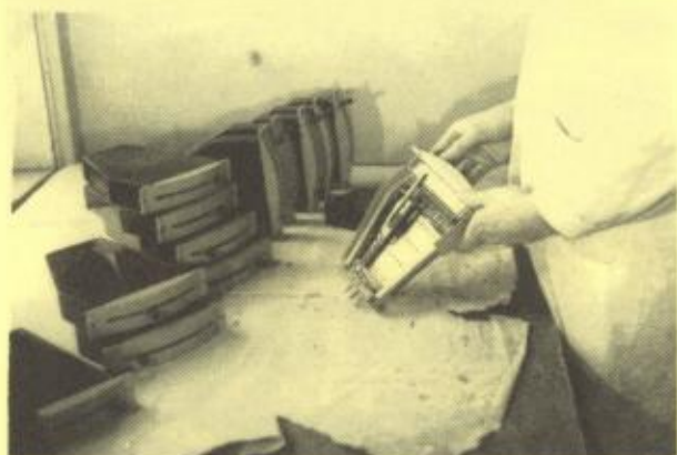
Az operaházi erősítőkhöz precíziós keverőegységek készülnek. A fenti erősítő profilszabályozói 0,05 M \Omega -os potencióméterek. Házi gyártás 1947.
