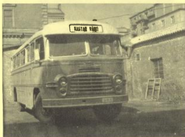
Ikarus 31 közvetítő kocsis. Épült 1957-ben, Lorenz V45a 4 csatornás keverő-erősítővel (NDK ajándék), Philips 10039/02 típusú, 76,2 cm/s szalagsebességű magnetofonokkal, a saját áramellátását biztosító 1,2 kVA-es motorgenerátorral és 6 db. 12V, 200 amperórás akkumulátorral. 1961-ben átépítésre került. A képek 1961-62-ben készültek. Az alsó képen Kalmár Sándor kábeles.
