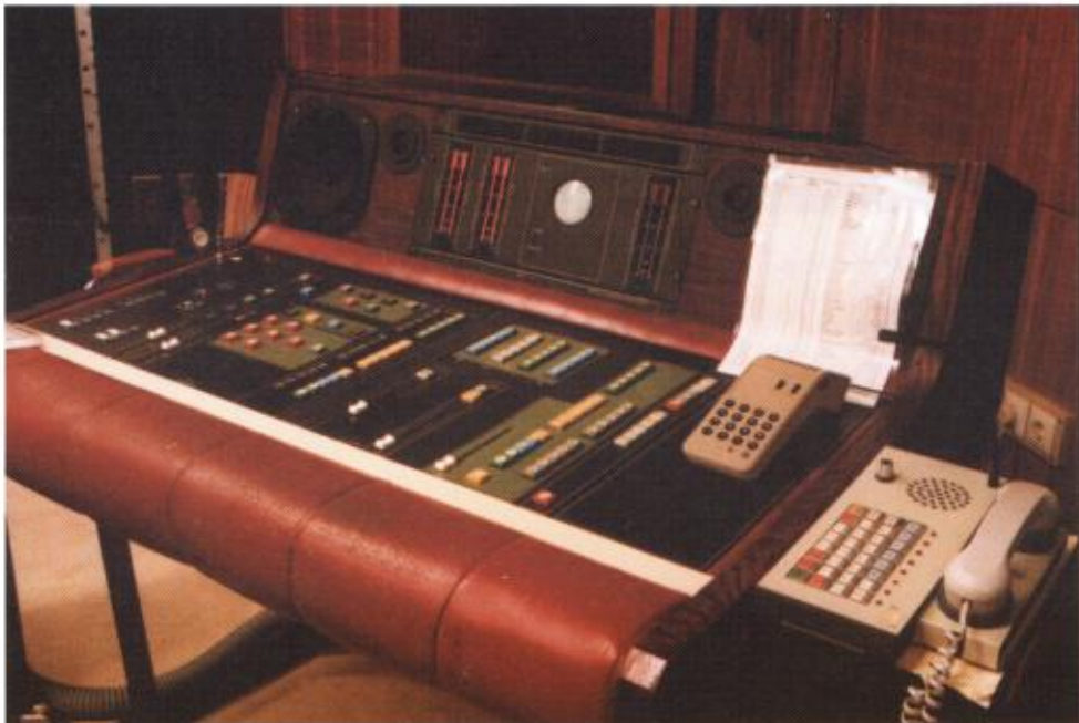
A BEAG által kifejlesztett és gyártott AC 200-AUT. (sz. gépes) adáslebonylító rendszer a 3-as stúdióban. 1998.
