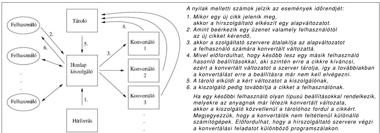
1. ábra A hírszolgáltatás működésének vázlata
