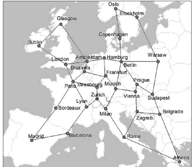
7. ábra ACOST 266 Európai referencia hálózat topológiája
