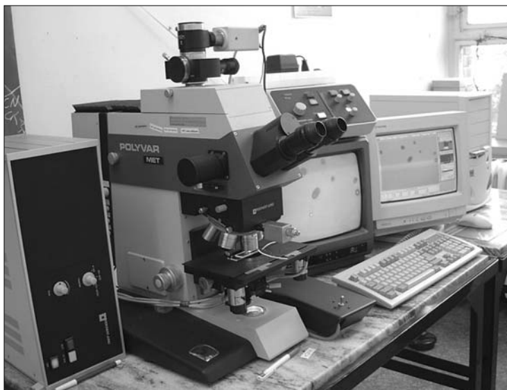
3. ábra Optikai mikroszkóphoz kapcsolt képanalizátor berendezés szilárdtest nyomdetektorok kiértékeléséhez (Pálfalvi József felvétele)
