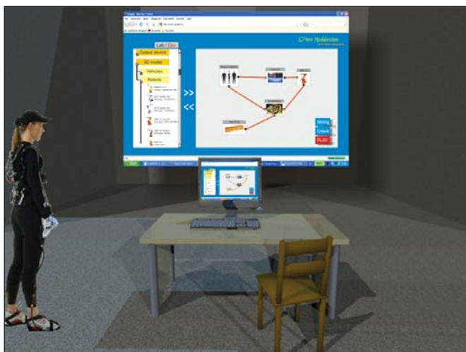
5. ábra „3D Internet”-re alapozott robotbetanítás koncepciója az iSpace Laboratory Network segítségével a) A távoli szakember b) A szakember által látott 3D virtuális valóság
