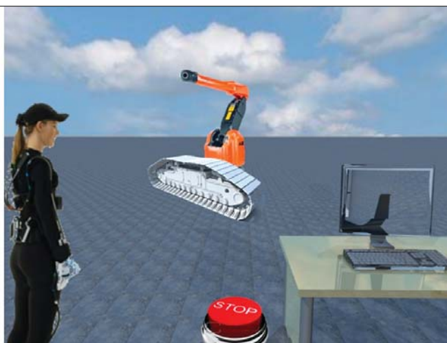
5. ábra „3D Internet”-re alapozott robotbetanítás koncepciója az iSpace Laboratory Network segítségével a) A távoli szakember b) A szakember által látott 3D virtuális valóság
