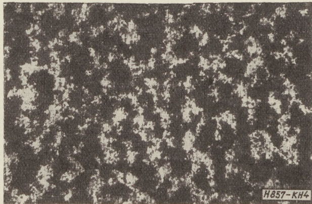
4. ábra. 1 jelzésű elektrolitkondenzátor-sorozat záróréteg-elektrolit határfelületéről készített fénymikroszkópos felvétel 10 000 órás elektromos és hőterhelés után ( 90\times )
