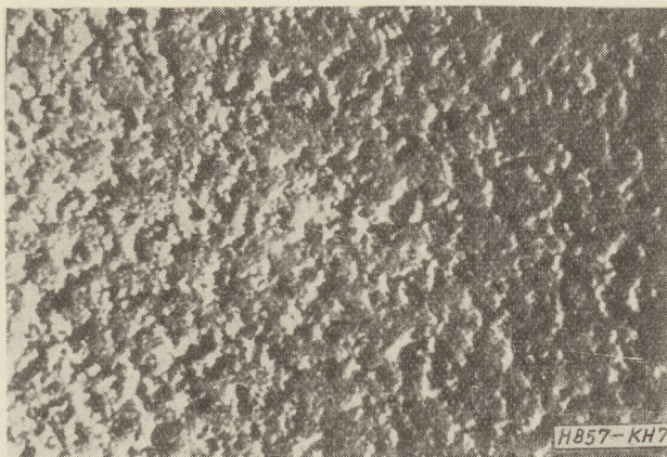
7. ábra. 9 jelzésű elektrolitkondenzátor-sorozat záróréteg-elektrolit határfelületéről készített fénymikroszkópos felvétel 10 000 órás elektromos és hőterhelés után (90×)
