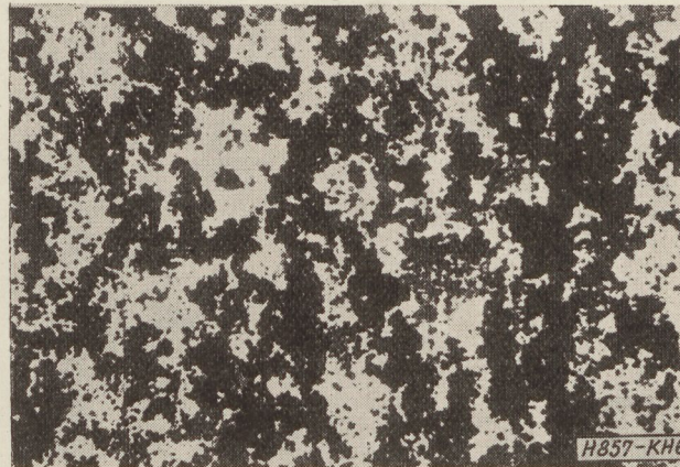
6. ábra. 18 jelzésű elektrolitkondenzátor-sorozat záróréteg-elektrolit határfelületéről készített fénymikroszkópos felvétel 10 000 órás elektromos és hőterhelés után ( 90\times )
