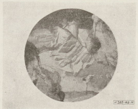
11. ábra. A feldurvított alumíniumanóda felületének elektronmikroszkópos képe ( 16000 \times )
