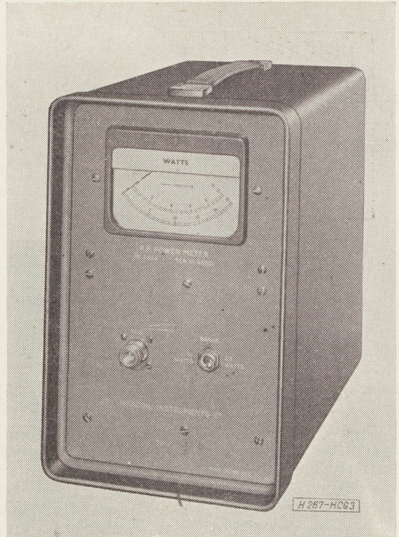
3. ábra. Marconi TF 1152 A-típusú, közvetlenül leolvasható abszorpciós típusú teljesítménymérő. Méréshatár 25 watt, egyenáramtól 500 MHz-ig használható. A bemeneti impedancia 50 ohm vagy 75 ohm
