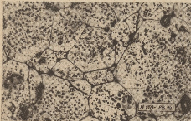
14. ábra. N11 típusú ferrit 2% CuO adagolással. A krisztallitokon belül maratási idomok. Kng fényesítés, Forró 1:1 HCl. Kisfilm. Nagyítás 320×
