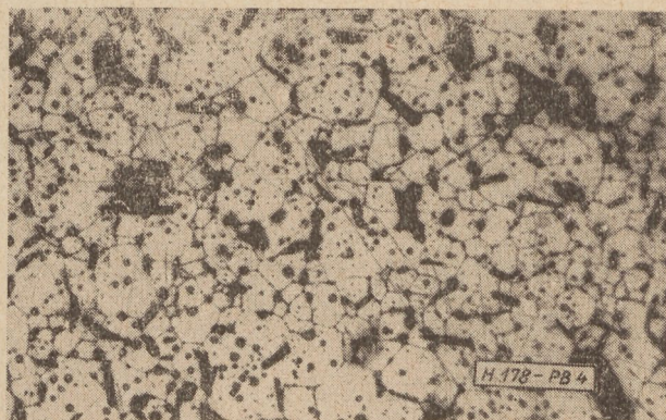
4. ábra. 64,4 súly-% Fe_2O_3 tartalmú NiZn ferrit. Világos, nem maródott x NiO Fe_2O_3 y ZnO Fe_2O_3 kristallitok. Sötétre maródott, tús kiválás. Kng fénnyesítés. Forró. 1 : 1 HCl. Kisfilm. Nagyítás 320x
