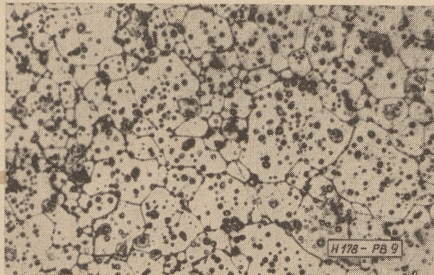
9. ábra. N11 típusú ferrit. Polygonális ferrit krisztallitok. 1300° C, 2 óra hőtartás. Az egyes krisztallitokon belül maradási idomok. Kng fényesítés. Forró 1 : 1 HCl. Kisfilm. Nagyítás 320 ×
