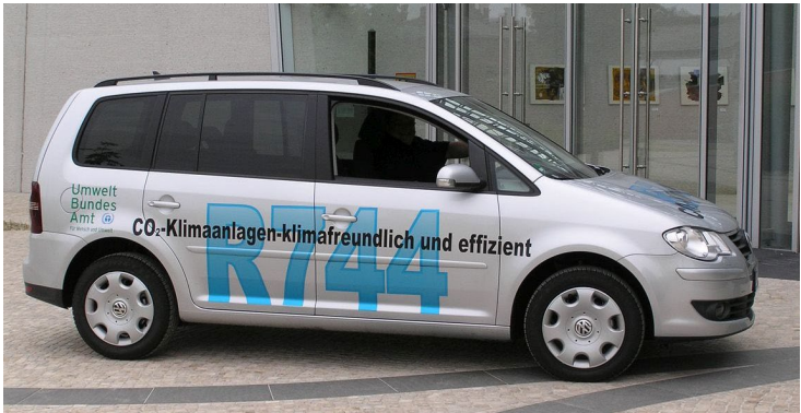
1. kép: Eddig csupán két autógyártó cég fejlesztett ki egyes személyautómodelljeihez olyan légkondicionáló berendezést, mely természetes hűtőközeggel, szén-dioxiddal (R744) működik
