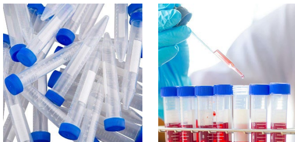
2. ábra: Eszközök 43 a csapadékminták mintavételezéséhez. Centrifugacsövek (polipropilén, névleges térfogat 15 ml) csavaros kupakkal (polipropilén).
