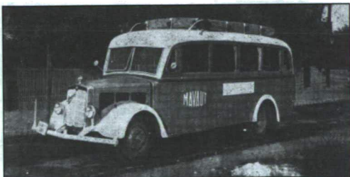
3. ábra „RÁBA SPECIÁL” TÍPUSÚ 30 SZEMÉLYES AUTÓBUSZ 80 LÓERŐS DÍZELMOTORRAL 1938-BAN
