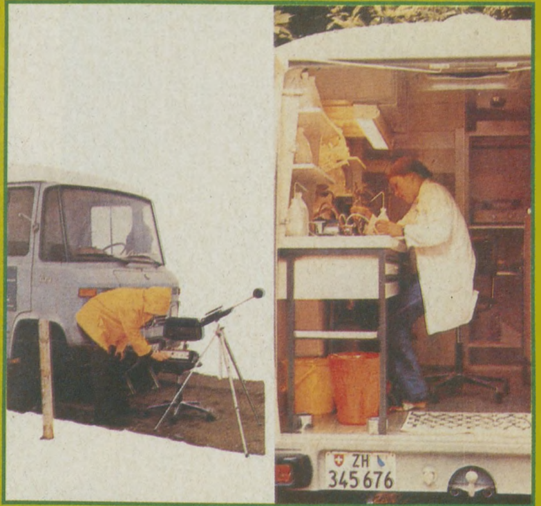
Mozgó környezetvédelmi laboratórium, melyben a víz-, a levegő- és a zajszennyezést és az időjárási adatokat mérik, sőt még hidrobiológiai vizsgálatokat is végezhetnek
