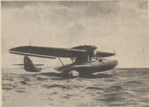
Német Dornier Do. 18 távolfelderítő hidroplán, mely típusnak forgalmi változata a délamerikai transzocéáni léglipostajáratot bonyolította le. Nyersolajmotorainak gazdaságos üzeme teszi lehetővé a nagy hatótávolságot
