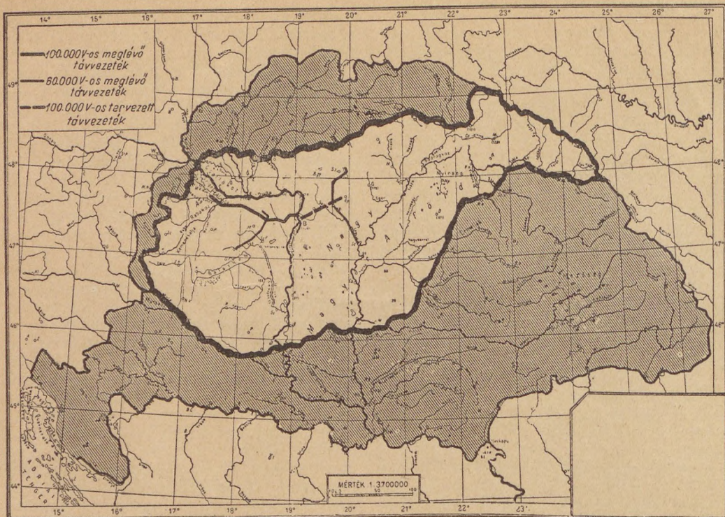
Csonkamagyarország legfontosabb villamos távvezetékkel. A Budapest-Mátravidéki tervezett szakasz meghosszabbításaként jól megépíthető majd a borsodi szénmedencéhez és kárpátaljai vízlerőkhöz menő távvezeték
