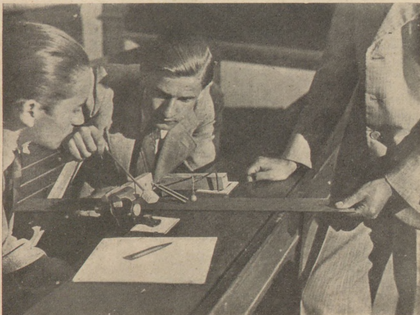
A hangvilla rezgésének lerajzolása és rezgésszámának mérése
