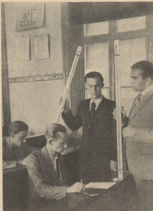
Boyle-Mariotte törvény igazolása. Az egyik végén beforrasztott üvegcsőben levegő van elzárva higányszállal
