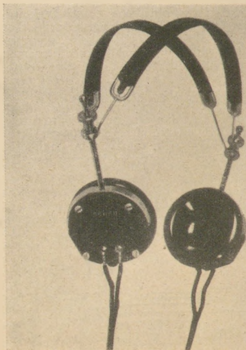
Fejhallgató, amelyben a hangot nem acéllemez, hanem kristály adja vissza
