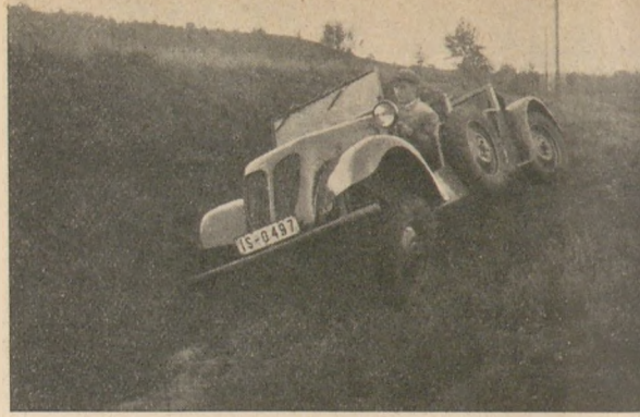
A «Tempo»-gyár terepjáró kocsija. A képen jól megfigyelhető a mozgathatóan felfüggesztett középső pótkerék szerepe. A konstrukció 2 motoros, 4 kerék-hajtású és 4 kerék-kormányozhatóságú első kerék, illetve farmmotoros megoldás
