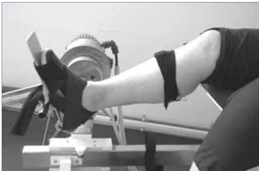
1. ábra. Lábpozíció a plantar és dorsalflexió irányban végrehajtott maximális akaratlagos izometriás erő kifejtés teszteknel Multicont II számítógép vezérlésű dinamométeren
