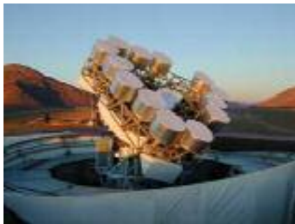
A Cosmic Background Imager 13 önálló, de egymással összekapcsolt és együttműködő rádióteleszkópból áll, amelyek mindegyike 90 cm átmérőjű. Az antennák a mikrohullámú tartományban interferométerként működnek
