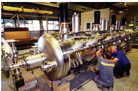
A nagyfrekvenciás elektromágneses teret keltő gyorsító-egység, szerelése
