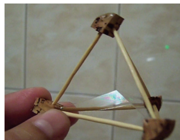
5. kép. A tetraéder szappanhártyája Látta-e már valaki szabad szemmel a tetraéder beírt körét? Gyufaszál, parafadugó és szappanoldat segítségével előállíthatjuk azt a minimálfelületet, amelynek közepén kirajzolódik a tetraéder körülírt köre is!
