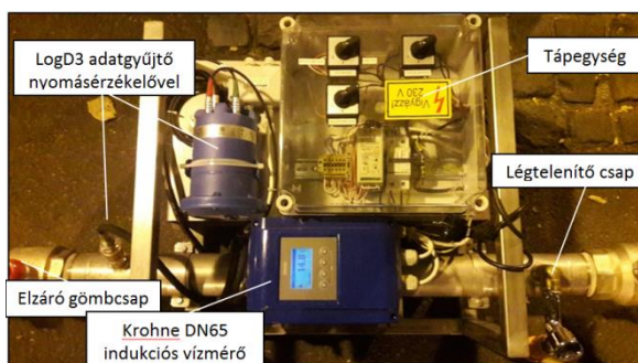
1. ábra. a mobil átfolyás mérő részei
