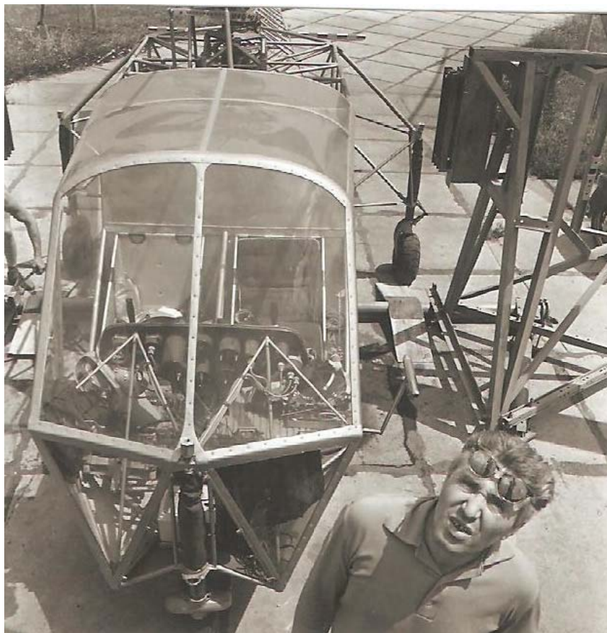
18. számú ábra. A felvételen jól látható a kísérleti helikopter kétüléses kabinja és botkormányai. Előtérben a berepülést végző Kaszás Imre helikoptertervező 86
