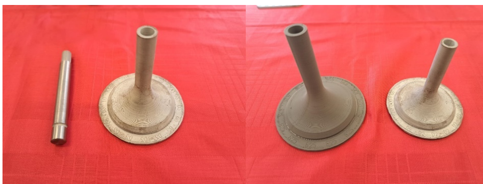
7. számú ábra. 3D nyomtatott Rába motor kipufogószelepek. Balra: a D2 szerkezeti acél szelep. Jobbra az Inconel 625 hőszilárd nikkelötvezetű anyagból mosás előtt készült sötétszürke szelep és a szinterezés utáni D2 anyagú szelep (fotó: Hegedűs Ernő)
