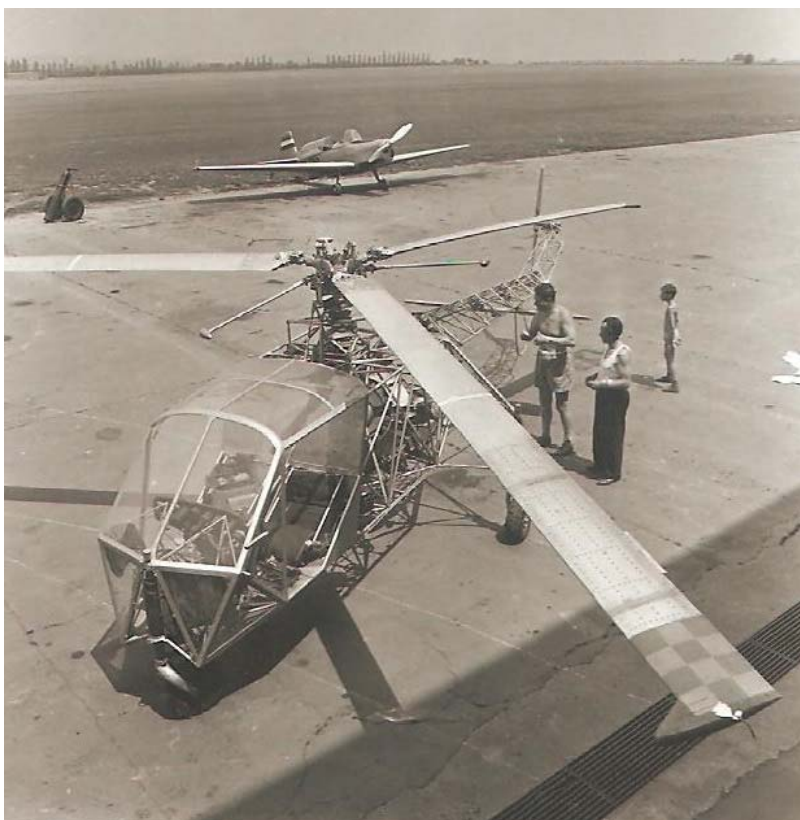
15. számú ábra. Az SOH-1 berepülésének előkészítése a Budaörsi Repülőtéren. Jól látható a háromlapátos forgószárny-elrendezés a röpsúlyos stabilizáló tömegekkel 81
