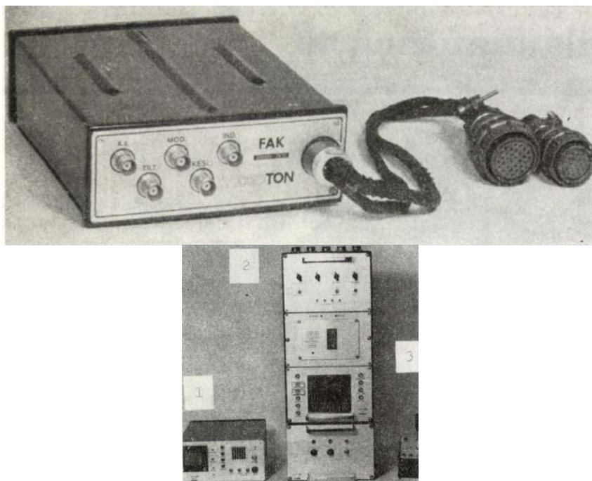
2. számú ábra. A repülőgép fedélzeti adatközlő-földi adatvevő rendszer fedélzeti (felül) és földi (alul) blokkjai
