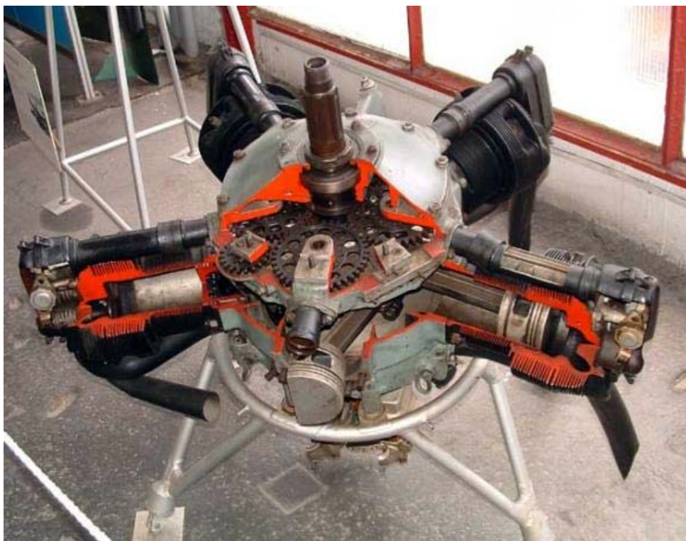
19. számú ábra. Az M-11FR motor metszete a volt Repüléstörténeti és Űrhajózási Állandó Kiállításban (Petőfi Csarnok) (Hajnal Sándor felvétele)
