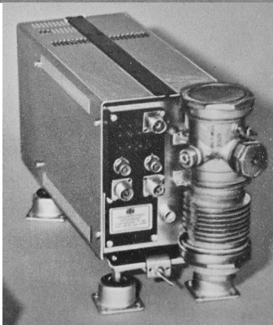
4. számú ábra. A FAK-FAV rendszer SzOD-57MA kísérleti változata (FAK-ot, magasságkódolót is tartalmazó fedélzeti aktív válaszadó, cserével „beépítve”)
