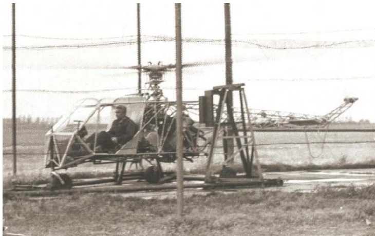
20. számú ábra. A kísérleti helikopter motorpróbai biztonsági kerítés mögött történtek 92
