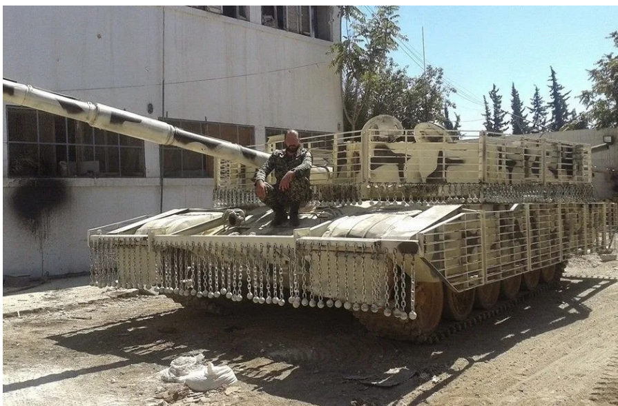
12. számú ábra. Egy szír T-72 alapharckocsi házi készítésű RPG-rácsokkal felszerelve [61]
