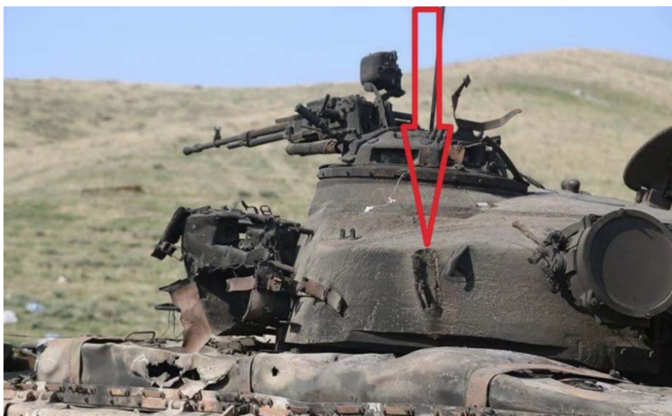
13. számú ábra. Egy örmény T-72B alapharcokocsit ért öngyilkos dróntalálat kumulatív sugarának bemeneti nyílása [65]
