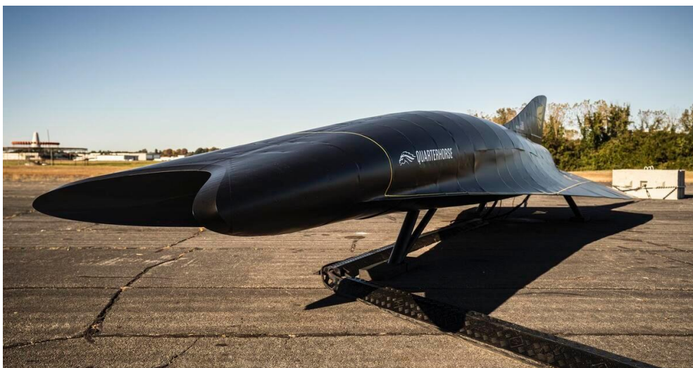
5. számú ábra. Az USA légierőnél a Hermus Quarterhorse hiperszonikus drón prototípusának tesztjeire készülnek. A kombinált gázturbinás-torlósugaras hajtóművet már tesztelik 25
