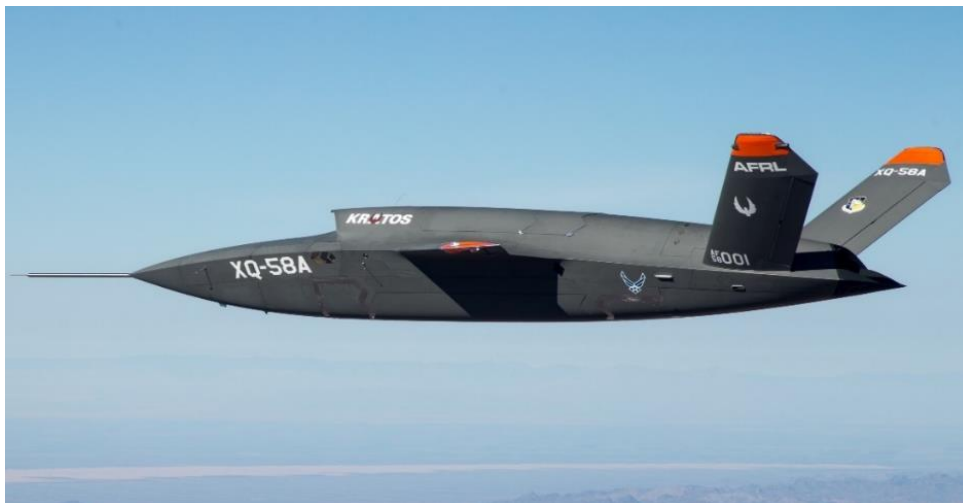
4. számú ábra. A pilóta nélküli XQ-58A Valkyrie lopakodó technológiát alkalmazó kísérleti repülőgépét AI irányítja 24
