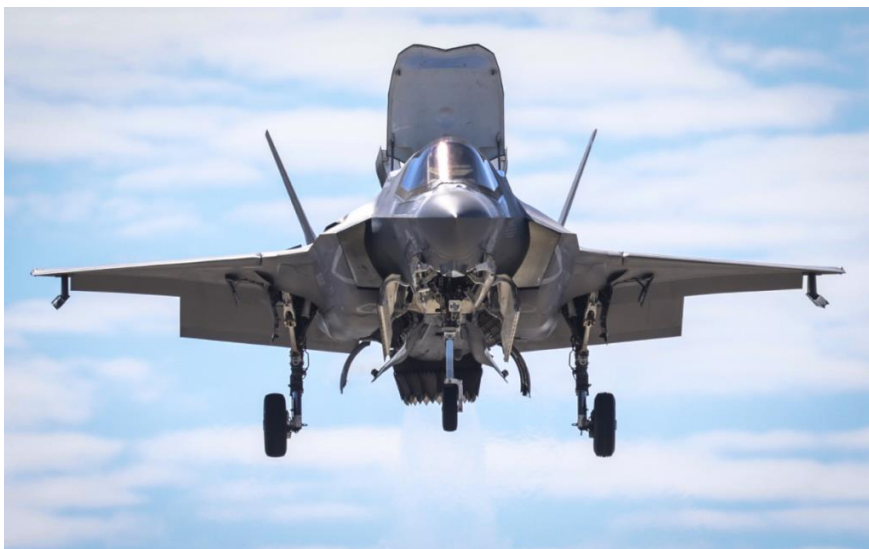
1. számú ábra. Az 5. generációs lopakodó képességű F-35 harci repülőgép B-változata STOVL képességű 9
