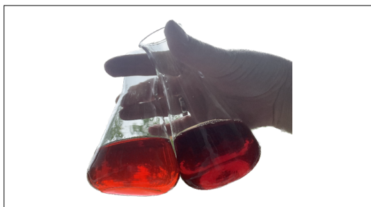
6. ábra. Végpontérzékelés. A házi készítésű eredeti vörösbormintának (baloldalt) és a titrált megfelelőjének (jobbaldalt) hasonló színeinek bemutatása – „2. Jodometria”
