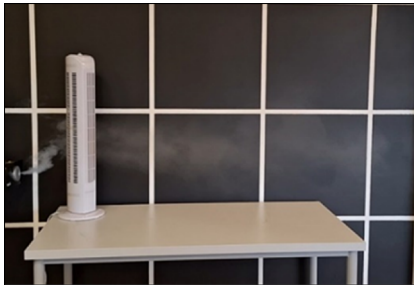
13. ábra. Toronyventilátor füstölése
