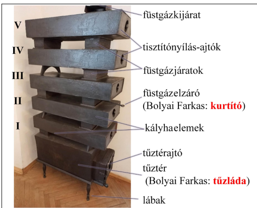
1. ábra. A tanulmányozott Bolyai-kályha felépítése
