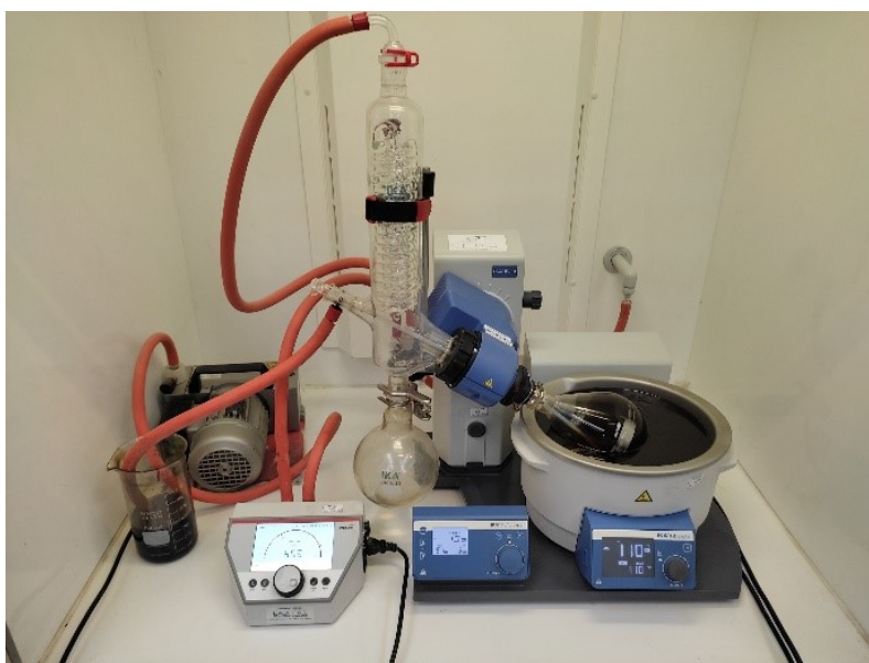
1. ábra: Beeresztőcsapos forgó bepárló, bitumen visszanyeréséhez.
