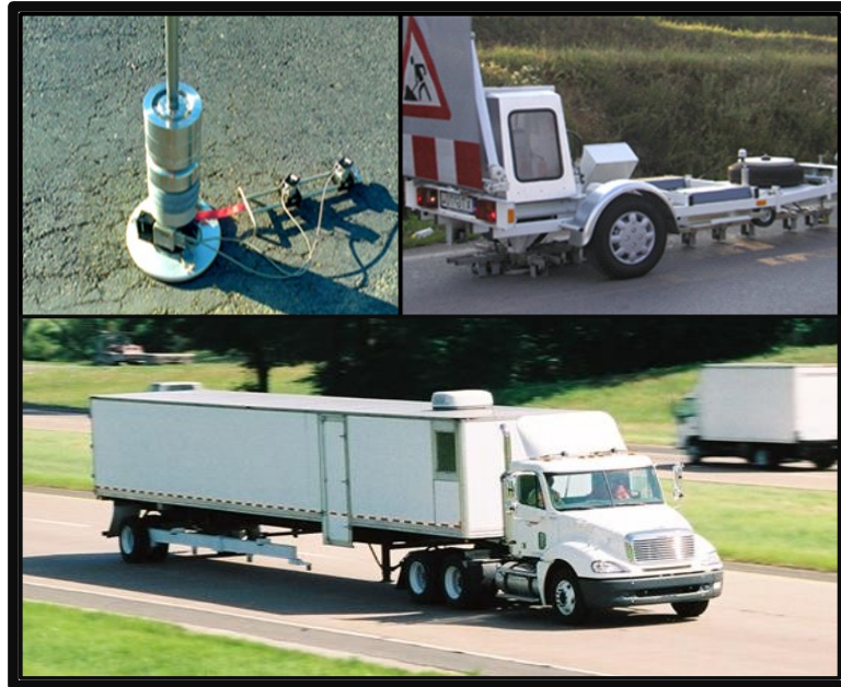
12. ábra: Különböző célokra alkalmazott ejtő súlyos berendezések.
