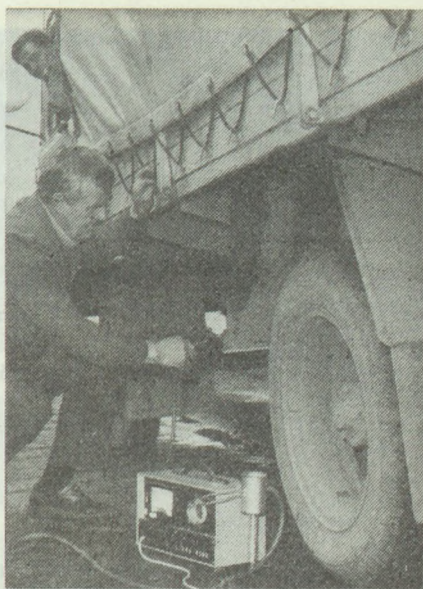
Közúti gépjármű-ellenőrzés a HITEKA szénmonoxid-mérő készülékével (Székely Tamás felvételei)
