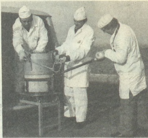
A szilárd, nagy aktivitású hulladék ölomkonténerben érkezik. A végleges elhelyezésig a Teletector sugárzómérő készülékkel folyamatosan figyelemmel kísérik a szállítmány útját
