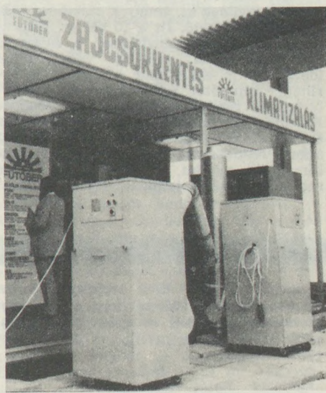
A változtatható helyű és szűrőbetétű (EL 1-4 típusú szűrőtáskákkal üzemeltethető), munkahelyi légszennyezést elszívó és leválasztó szekrények mindenféle szennyeződéstől gyorsan és kifogástalanul tisztítják meg a munkahelyi levegőjét
