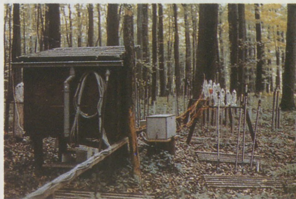
Szabadtéri laboratóriumok mérőműszerei és talajszondái mérik az NSZK erdeiben a talajba rakódó és a gyökerekbe, valamint a fa különböző részeibe eljutó anyagok mennyiségét
