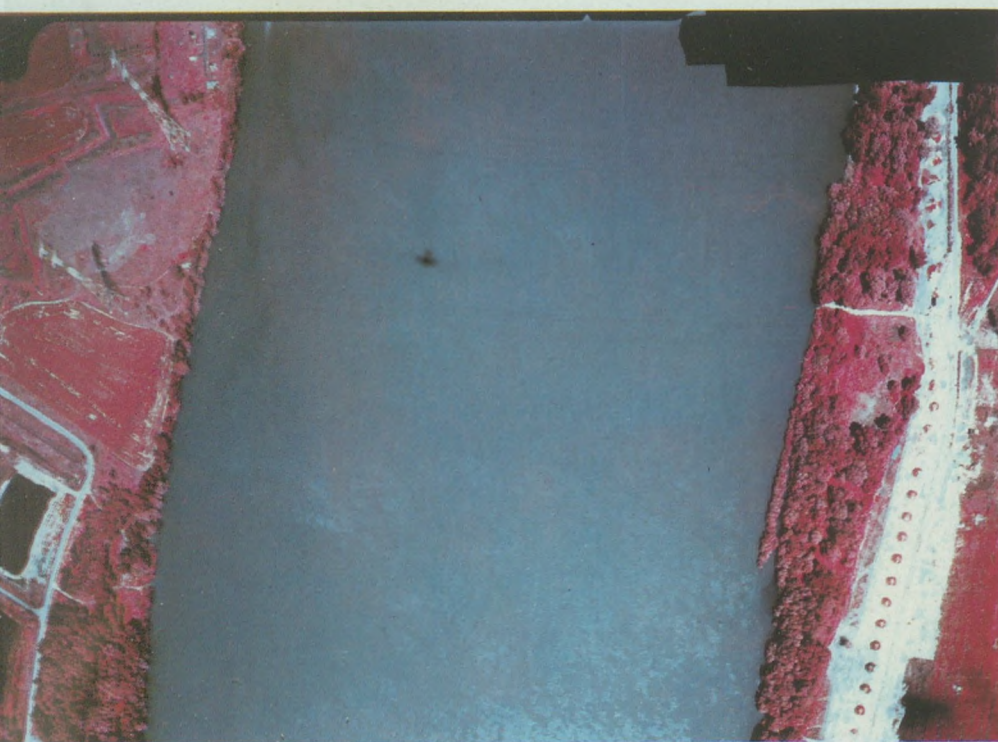
3. Ez a képünk az iménti helyszínen készült egy évvel később, színes infratechnikával. Jól látszik a táj változása: a kép jobb oldalán a vízkivételi mű kiépítése, ahol a környezet egy részét már füvesítették, ez viszont itt piros színben tűnik elő
