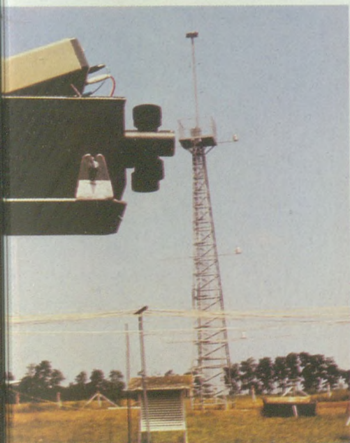
6. Munkában a terepi spektrométer, amellyel a visszavert sugárzást mérjük
