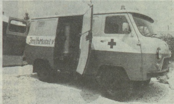
VAZ terepjáró gépkocsira szerelt, óránként 3 m 3 /óra teljesítményű Pannónia Aqua Filter berendezés
