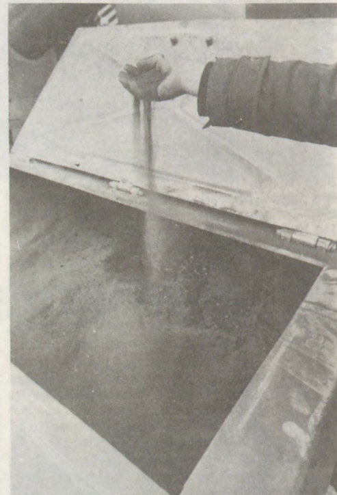
A kommunális szennyvíziszapot a szombathelyi szennyvíztisztító telepen forgóhengeres kazánokban kiszáritják és porítva hozzák forgalomba
