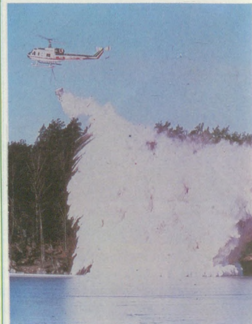
A savas csapadékvíz lemosódásától alacsony hidrogénion-koncentrációjúvá vált svéd tóba helikopterről égetett mészpórt szórnak
