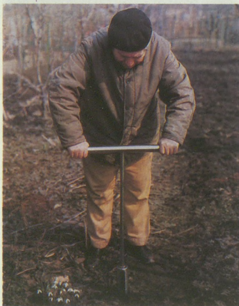
A talajmintavétel kézi talajfúró segítségével jelentősen megkönnyíthető. (Szekely Tamás felvétele)
