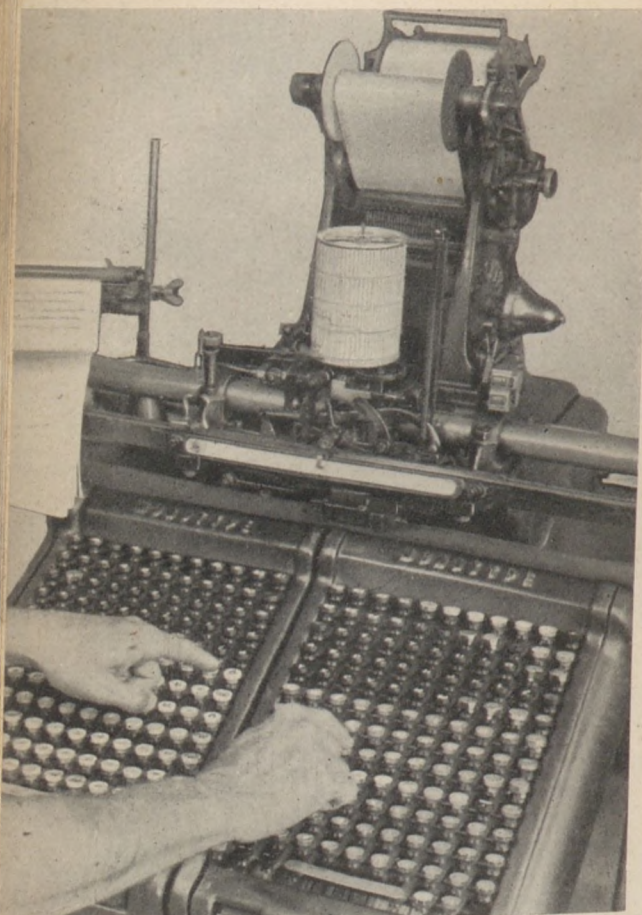
Monotype szedőgép. A billentyűzet azért olyan nagy, mert háromféle betűtípus felhasználása lehetséges
