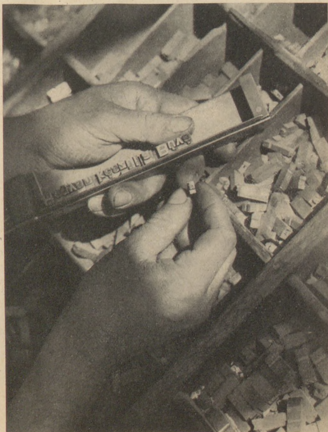
A szedő munkában. A sorzóban a szedőszekrényből kiemelt betűket egymasmellé helyezi
