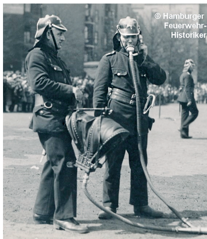
14. ábra: A König-féle füstsisak tényleges működése, telefonos kézibeszélővel és Y elemmel Forrás: HEGEMANN 2022
