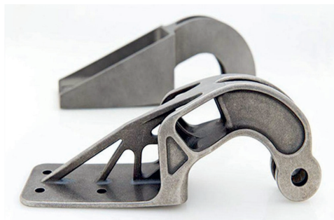
8. kép: Eredeti, hagyományos technológiával tervezett és gyártott, illetve topológiai optimalizált Airbus tartó
