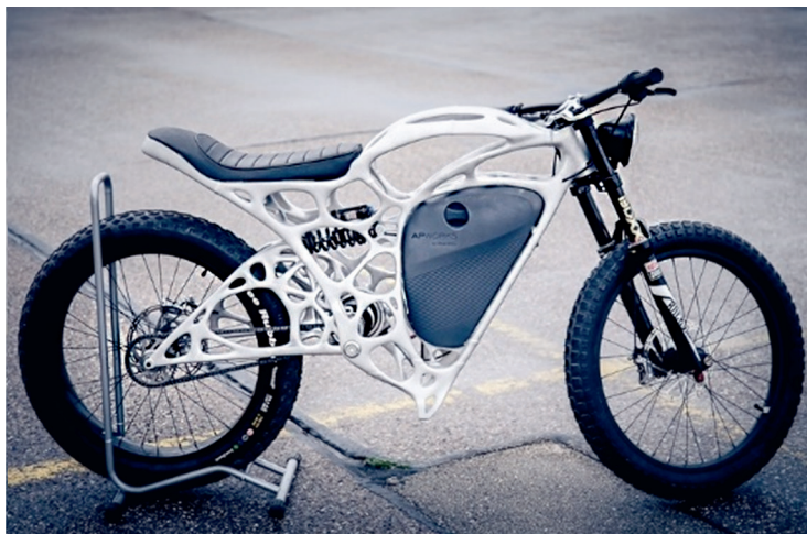
4. kép: Az Airbus APWorks elektromos motorkerékpár topológiaiilag optimalizált 3D-s nyomtatott fémváza, amely mindössze 6 kg tömegű
