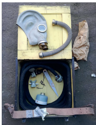
10. ábra: A magyar Medicor Művek által üzemi polgári védelem számára gyártott szívó típusú friss levegős légzőkészlet az 1980-as évekből
