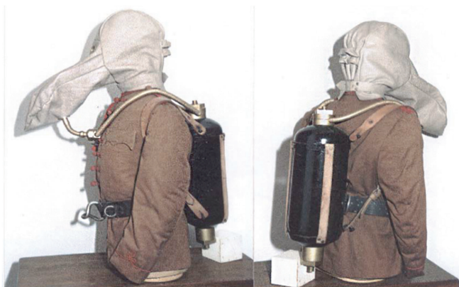
1. ábra: A Kőszeghi-féle „életmentő készülék” hordhelyzetben
