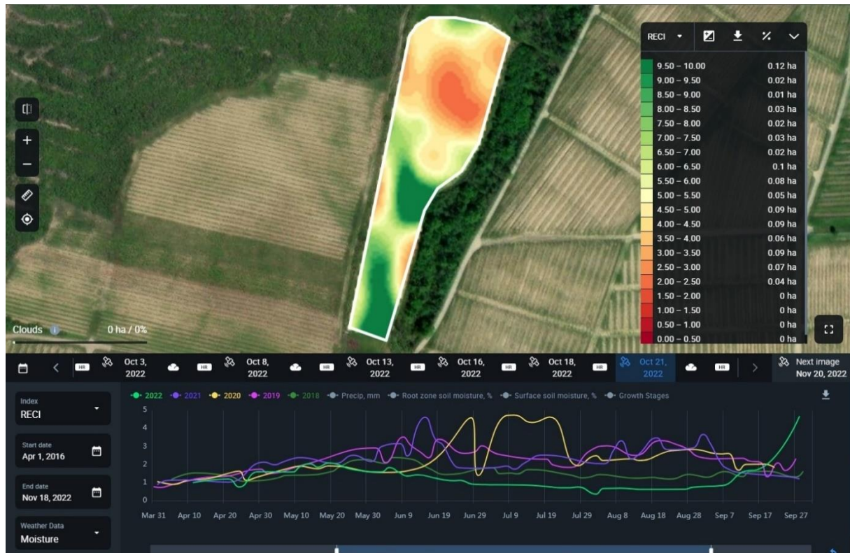
5. ábra A fajtagyűjtemény távérzékeléses RECI interpolált térképe (2016-2022), jobbra a színek értelmezési tartománya (legendje), illetve az értékek változása az évek során (lenti görbék) (forrás: EOS)
