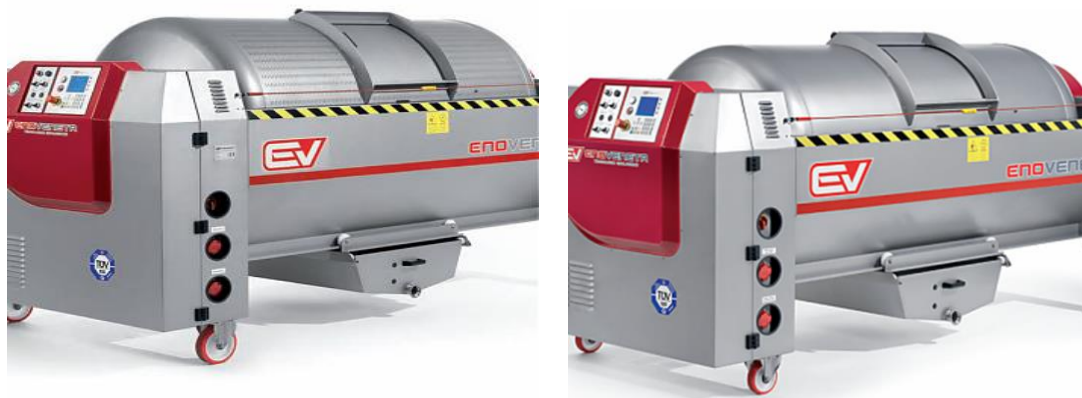
6. ábra: Nyitott és zárt kivitelezésű pneumatikus prés (Forrás: http://keszenlet.hu/enoveneta-presek/ )
