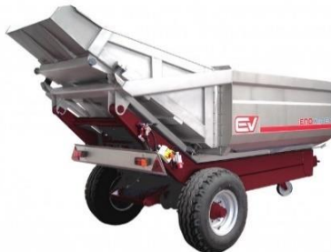
3. ábra: Enoveneta hidraulikus emelésű vibrációs kihordású szüretelőkocsi (Forrás: https://keszenlet.hu/boraszat/termekek/ )
