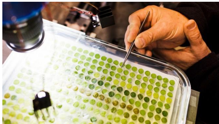
3. ábra: Automatizált képalkotó rendszer a mikroszkóppal, kamerával (balra), illetve a tálcára helyezett levélkorongokkal (jobbra) (Forrás: Wines & Vines; Cornell Chronicle )
