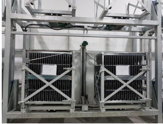
8. ábra: Giropalettázó a Bodrogkisfaludi üzemben (Forrás: www.landmarktokaj.hu )
