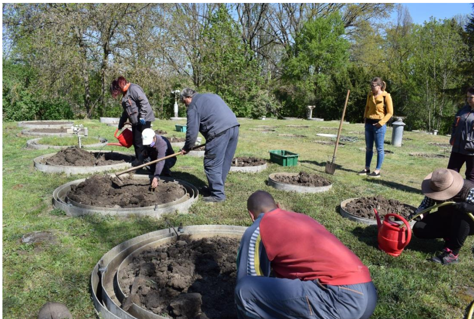
5. ábra: A súlyliziméter egységek telepítése (Forrás: saját szerkesztés)
