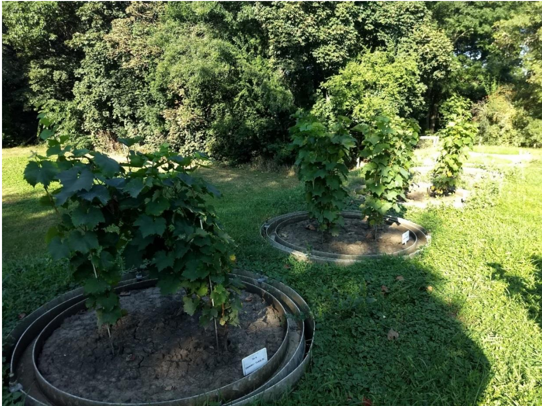
2. ábra: Súlyliziméter egységek az eltelepített szőlő oltványokkal (Forrás: saját szerkesztés)
