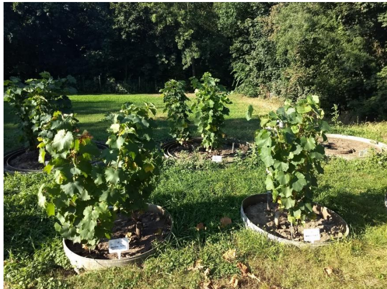
4. ábra: Kompenzációs rendszerű liziméter egységek az eltelepített szőlő oltványokkal (Forrás: saját szerkesztés)
