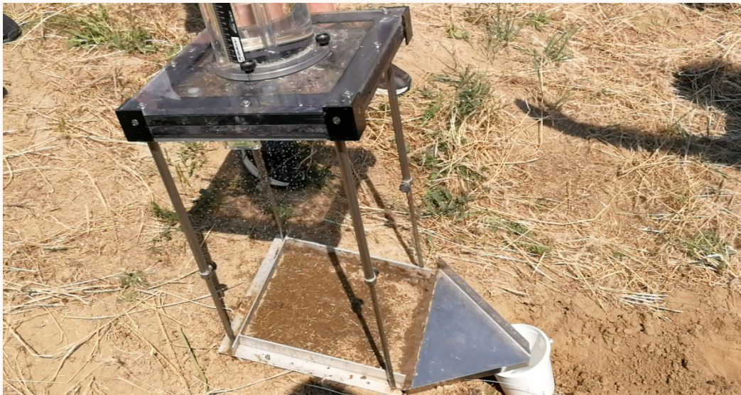
3.kép A nem művelt talajfelszín erózióérzékenységének mérése
