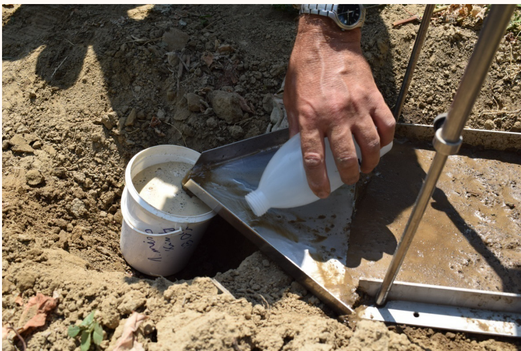
4.kép A művelt talajfelszín erózióérzékenységének mérése
