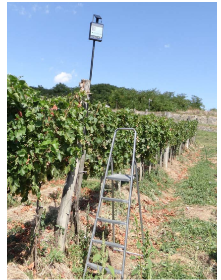
4. kép A szondákkal, illetve a központi szerverrel kapcsolatot biztosító egység (logger)
