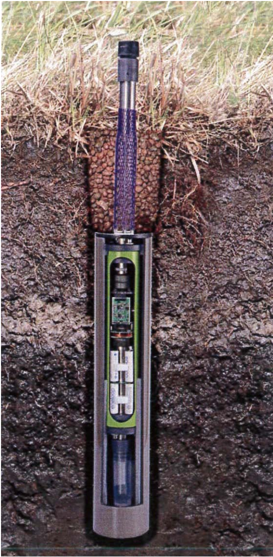
1. kép Az EDAPHOLOG rendszer szondájának elhelyezkedése a felső talajszelemben
