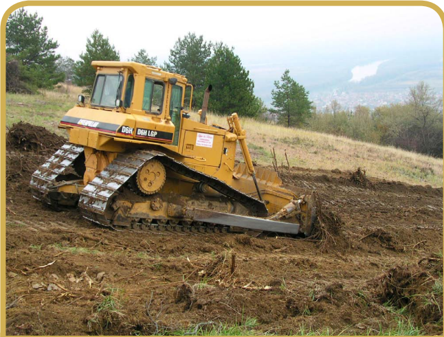
2. ábra A tolólappal erőgép (dózer) könnyedén forgatja ki a talajból a gyökérzetet
