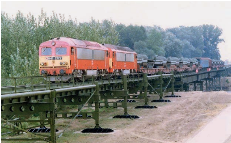
10. ÁBRA. Lakitelek és Tiszaug közötti vasúti provizórium REM-500 típusú parti nyílásokkal [23]
