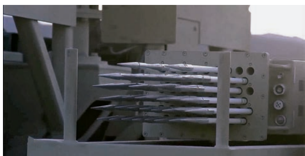
17. ÁBRA. Egy pálcákkal feltöltött adagolóegység a járműtestre fektetett menethelyzetben [12]
