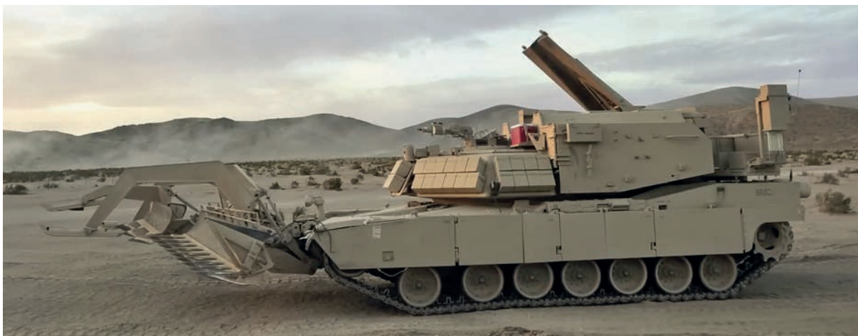
15. ÁBRA. A sávjelölő és az egyik szalagtöltet munkahelyzetben, az eke menethelyzetben [10]
