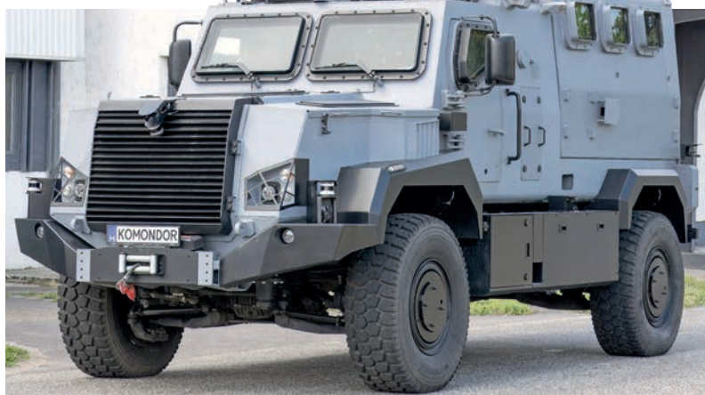
7. ÁBRA. RDO-3927 Komondor, kombinált (CBRN-felderítő + sebesültszállító) felépítménnyel (A szerző felvételei)
