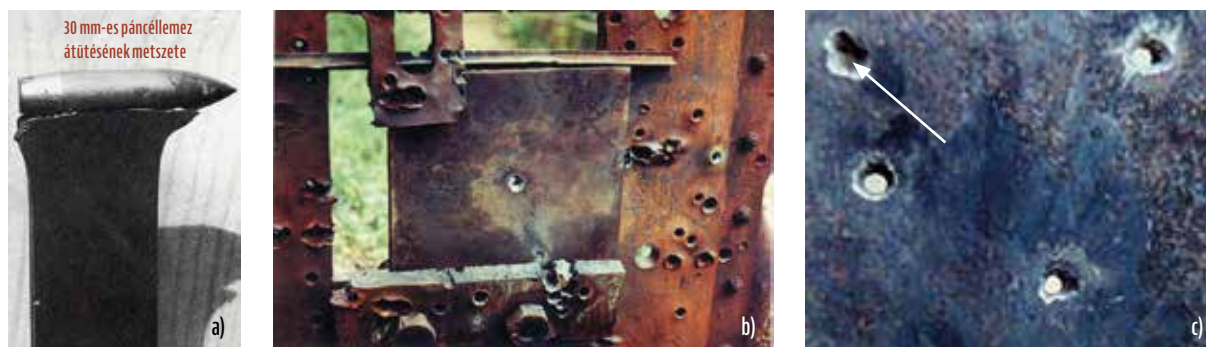
75. ÁBRA. Páncéllemez-átütések 100 méterről: a) egy 30 mm-es lemez átütésének függőleges középsíkjában készített metszet, a B32 lövedék utólag beleszabtott edzettacél magjával; b) 25 mm-es páncéllemez átütése; c) 20 mm-es páncéllemez átütése
