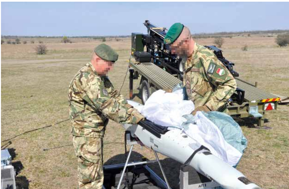
10. ÁBRA. A légsákrendszer behajtogatása (A szerző felvételei)
