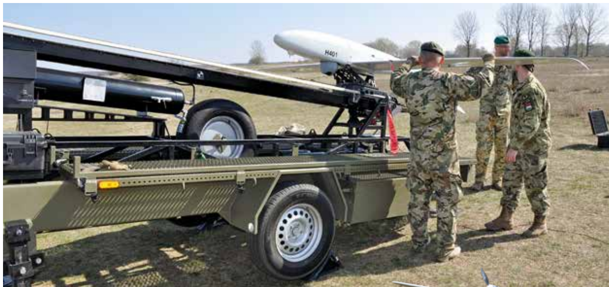
7. ÁBRA. A szárnyak felszerelése (A szerző felvétele)
