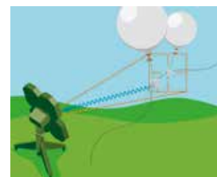
telepített RT20A rádióteodolit
