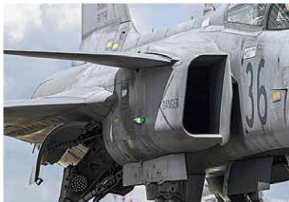
6. ÁBRA. Határréteg-leválasztó a szívócsatorna-beömlőnyílás és a törzs közötti részen sárgával jelölve egy Saab JAS-39 Gripen C típusú repülőgép esetében (Forrás: HM Zrínyi Nkft. / honvedelem.hu)
