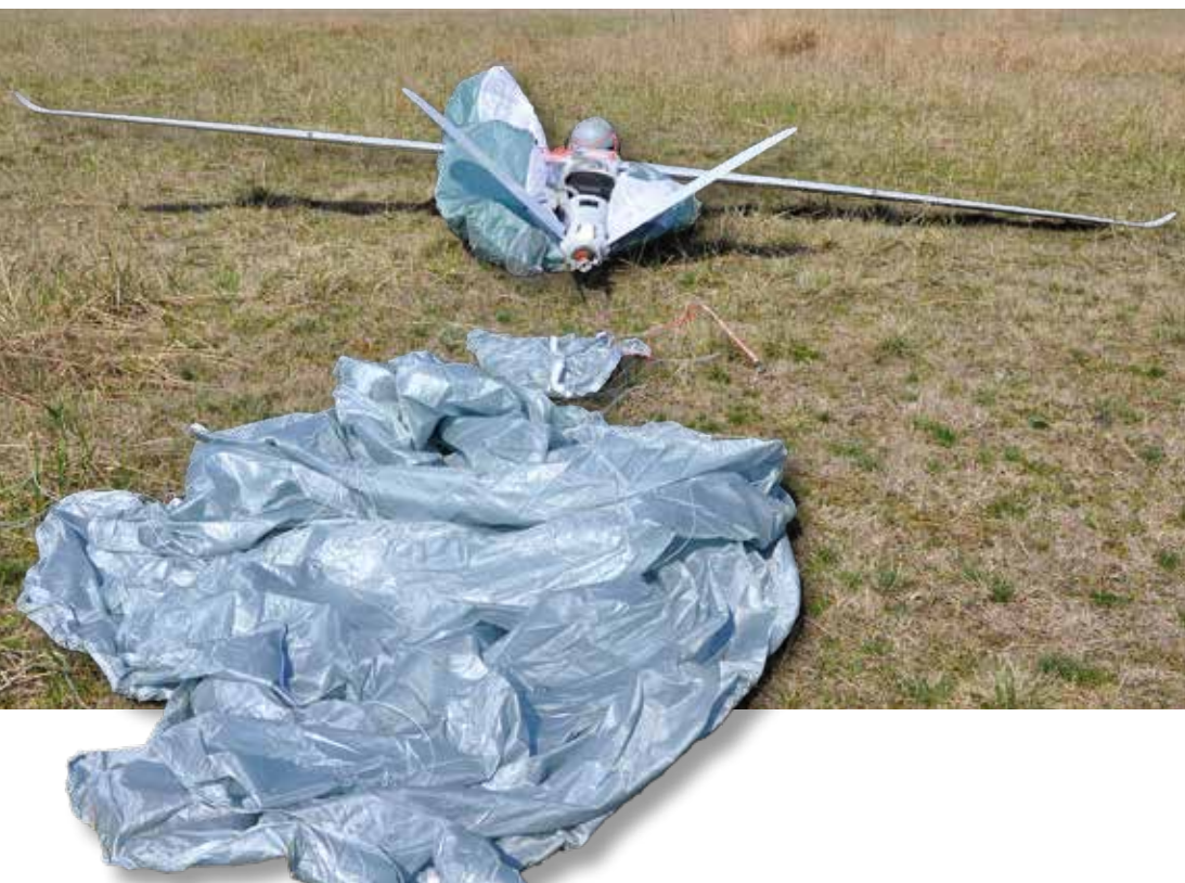
11. ÁBRA. Skylark 3 leszállás után, leengedett légsákrendszerrel és ejtőernyővel (A szerző felvétele)
