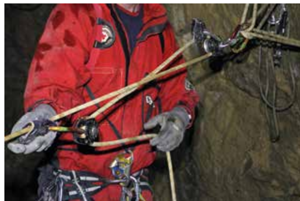
22. ÁBRA. „Flaschenzug” – a kötélt visszafutását gátló húzórendszer
