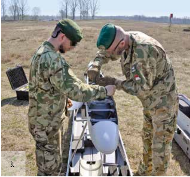
3. ÁBRA. A Skylark 3 összeszerelése a tárolórendszerben kialakított állványon (A szerző felvétele)
