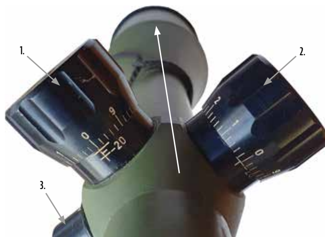
80. ÁBRA. A CSZ távcső finombeállítását biztosító részegységek: 1. magasságiszög-beállító forgatógomb, 2. oldalszög-beállító forgatógomb, 3. száldereszt-megvilágítás kapcsoló. A fehér nyíl a szemlencse irányából a tárgylencse irányába mutat
